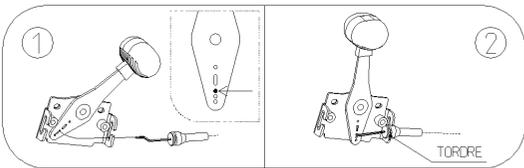
**Schéma 1 :** Insérer le Z du câble accélérateur dans le troisième trou de la poignée (située sur la traverse du guidon)
